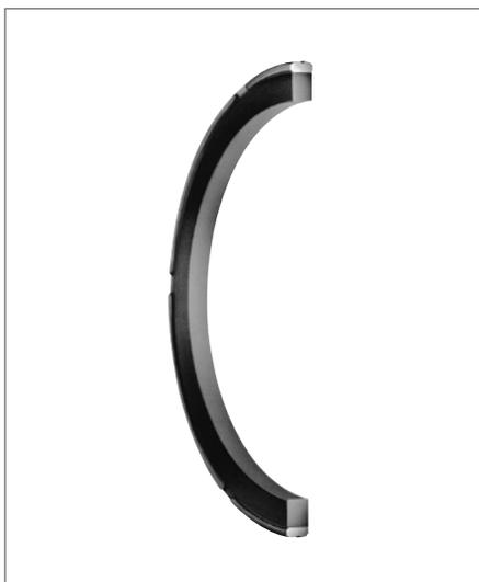
Der Ultrathan®-Kolbendichtsatz Profil KR ergänzt die Produktpalette der doppelwirkenden Kolbendichtungen (OE, OK) für Einbauräume nach ISO 7425-1 um ein Produkt, welches vorzugsweise im Druckbereich bis max. 300 bar eingesetzt wird. Die Dichtung besteht aus einem Gleitring eines neuentwickelten Polyurethans mit verbesserten Gleiteigenschaften und besonders hohem Modul und einem Vorspannelement mit Rechteck-Querschnitt aus einem NBR-Elastomer.
